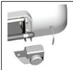
Vergewissern Sie sich, dass der Temperatursensor im Wasser eingetaucht ist, um eine korrekte Wassertemperatur ablesen zu können.
