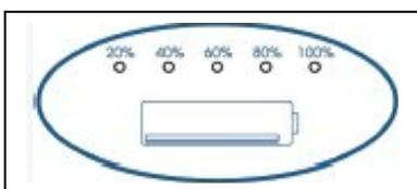
Die Batterieanzeige zeigt den Stand der Batterie an. Bei einer voll aufgeladenen Batterie werden 100% angezeigt. Bis zu einem Stand von 80% wird ein grünes Licht, bei einem Stand von 60-40% ein gelbes Licht angezeigt. Ist der Stand der Batterie darunter angelangt, wird ein rotes Licht angezeigt. Sobald die Batterie einen Stand von 20% erreicht hat, stoppen Sie bitte sofort die Benutzung des Gerätes, bis die Batterie wieder aufgeladen ist.
