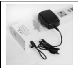
Verbinden Sie das mitgelieferte Ladegerät mit der Batterie und stecken Sie den Stecker in eine Steckdose.
