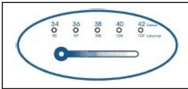
Die Temperaturanzeige gibt die Wassertemperatur an. Wenn das Badewasser kälter als 34°C ist, wird kein Licht aufleuchten. Sobald das Wasser eine Temperatur von 34-38°C erreicht, leuchtet die Anzeige grün. Bei einer Temperatur von 40°C ist die Anzeige gelb, ab 42°C rot. Kontrollieren Sie vor jedem Bad die Wassertemperatur. Bitte beachten Sie, dass eine Wassertemperatur von 42°C und mehr für einen normalen Nutzer zu hoch sein kann.
