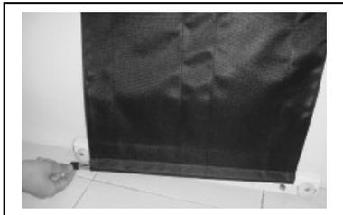
Die Verankerungsschiene muss sicher auf dem Badezimmerboden direkt gegenüber des an der Wand montierten Gehäuses befestigt sein. Der Tuchfixierungsstab kann von der Schiene entfernt werden, indem die beiden Räder aufgedreht werden und das Tuch in das Gehäuse zurückgerollt wird. Dies ermöglicht eine normale Benutzung der Badewanne.
